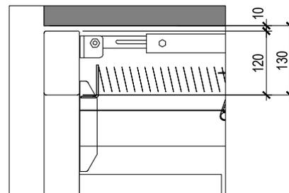
Détail coupe pose affleurante avec moteur Supramatic
